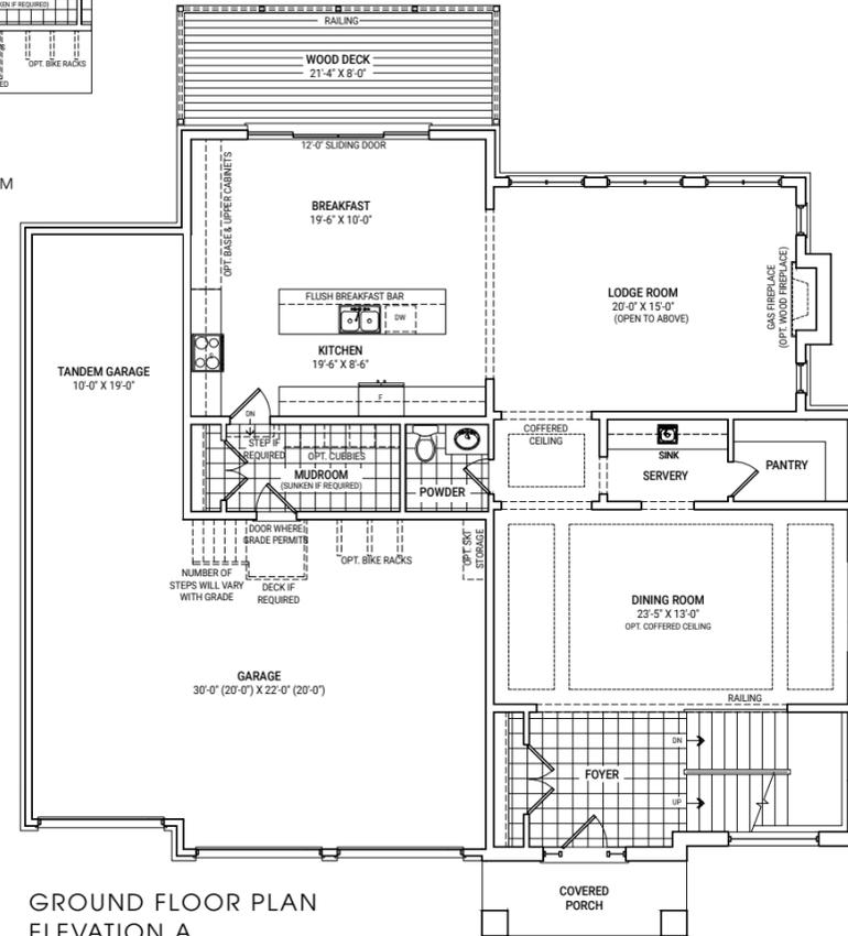
GROUND FLOOR PLAN ELEVATION A
